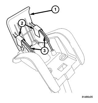
Fig. 1 SEAT BACK RELEASE HANDLE / CABLE
